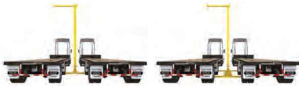
La base del braccio può ruotare di 90°
