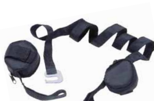
AKIS01 FASCE DI SOSPENSIONE Applicabili a tutti i tipi di imbracature. Appositamente studiate per alleviare gli effetti negativi di una temporanea sospensione a seguito di una caduta. In caso di necessità, estrarre le due fasce, legarle tra loro e appoggiare i piedi sulla fune di sospensione ottenuta, in attesa dei soccorsi (vedi foto). Confezione: 1 paio
