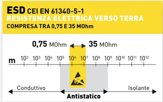
ESD = Electro Static Discharge (scarica elettrostatica)
